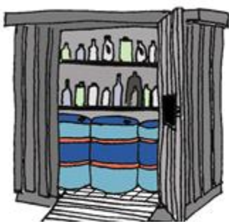
Figur 2 Udendørs opbevaring i container med dobbelt bund.
