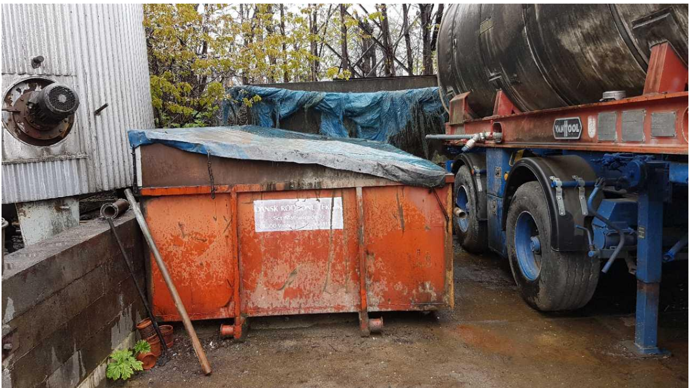
Container til olieforurennet jord.
