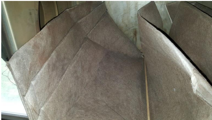
Renluftsiden af filter
