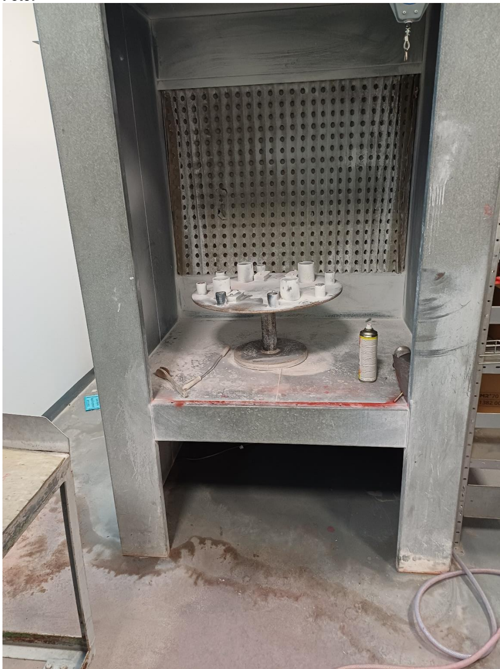
Kabine til påførsel af fremkalder (kridt)
