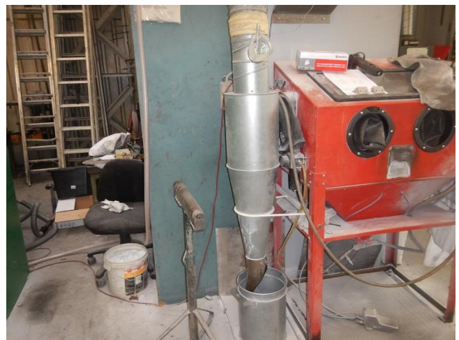
10. Sandblæsningskabine, udsugnings luft afkastes efter filter til rumluften, Der anvendes galsblæsemiddel
