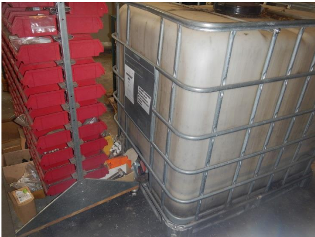
7. Pallettank til oplag af brugt skærevæske (olieaffald)
