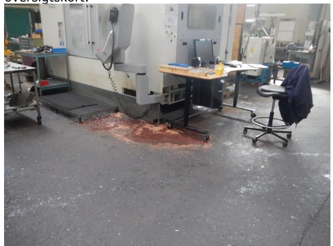
6. Skærevæske på gulvet opsuges med kattegrus
