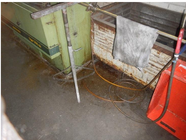
5. Skærevæske ses på gulvet omkring fra maskine
