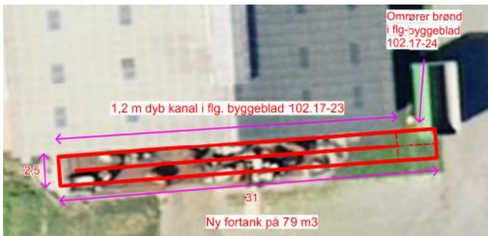
Figur 2. Målsat skitse af fortank og omrørerbrønd
