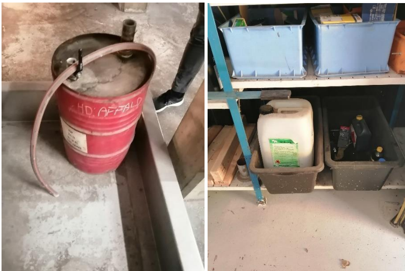
Billede 5. Oplag af hydraulikolieaffald på betongulv med afgrænset med betonkant sammen med hydraulikolier (billede 4). Oplag af kølevæske og diverse kemikalier i værksted i hovedbygning
