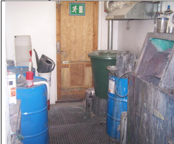
Opbevaring af kemikalier og anlæg for rensning af sprøjtepestoler (den grønne beholder i baggrunden) i fortynderrum, placeret på spildebakker med sump
