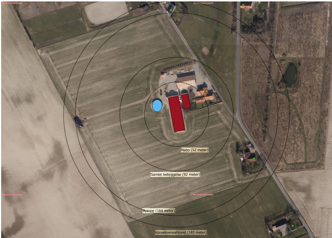
Figur 2.1: Illustrativ indtegning af anlæggets geneafstande til enkeltbolig, samlet bebyggelse og byzone. Geneafstandene er tegnet som buffere rundt om ejendommens ca. lugtmidtpunkt. Naboobeboelser er angivet med grønne cirkler.
