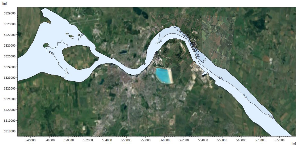
Figur 4-9. Temperaturforskel ved spredning af maksimalt nedkølet kølevand fra havvandsvarmepumpen under forhold med østgående strøm.
