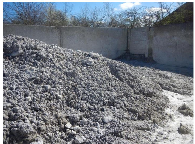
4. Betonaffald til hærkning i betonindhegning
