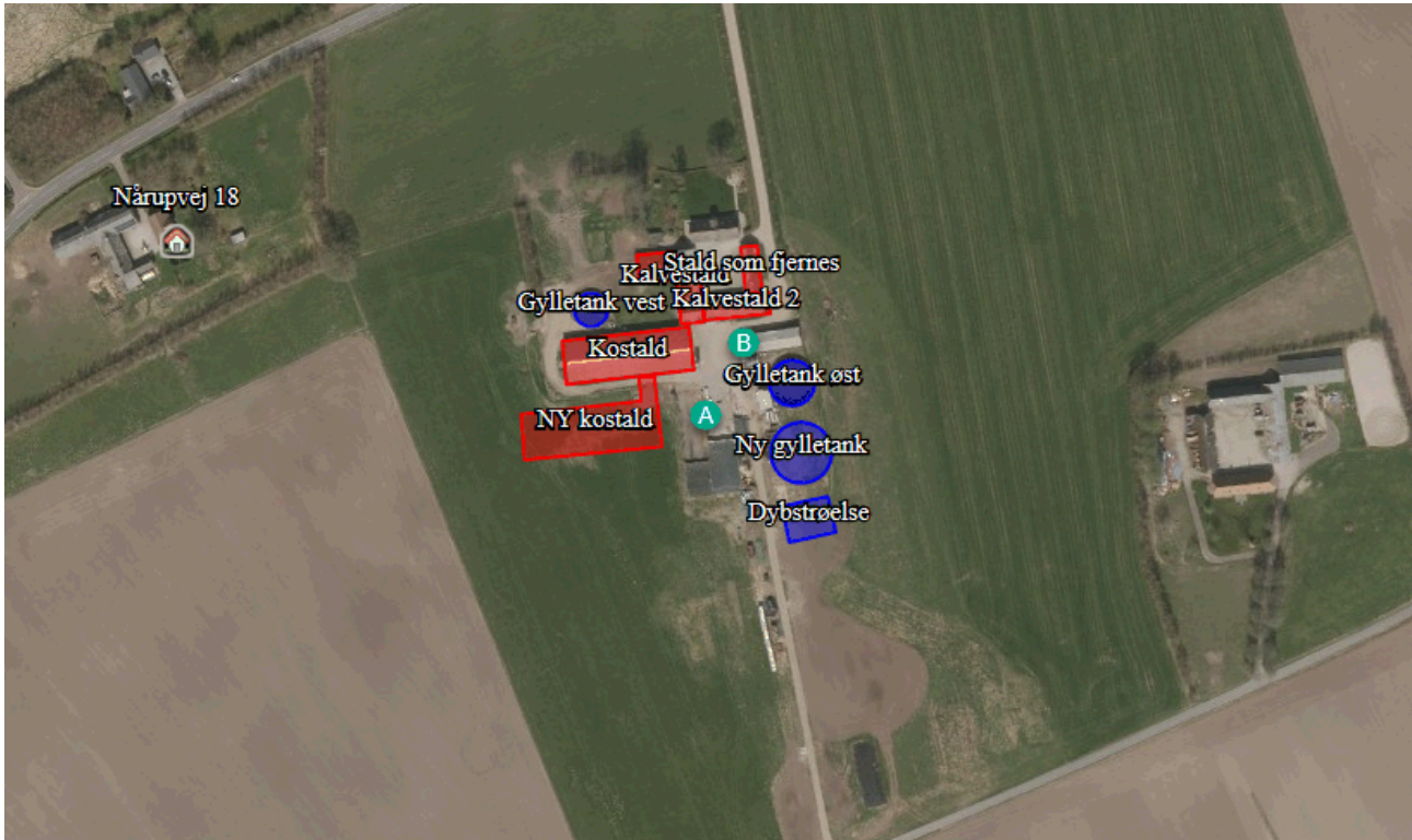
Figur 5: Oversigtskort med placering af potentielle støjkilder. A: K04 blanding af grovfoder, B: K02 indblæsning af foder
