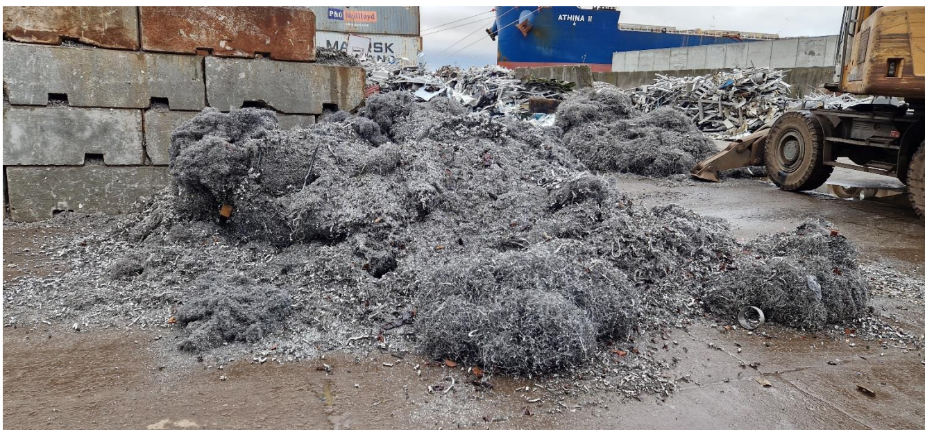
Rustfri drejespåner med køle-/smøreolie blev opbevaret uoverdækket på pladsen hvor der ikke er afledning til en opsamlingstank.
