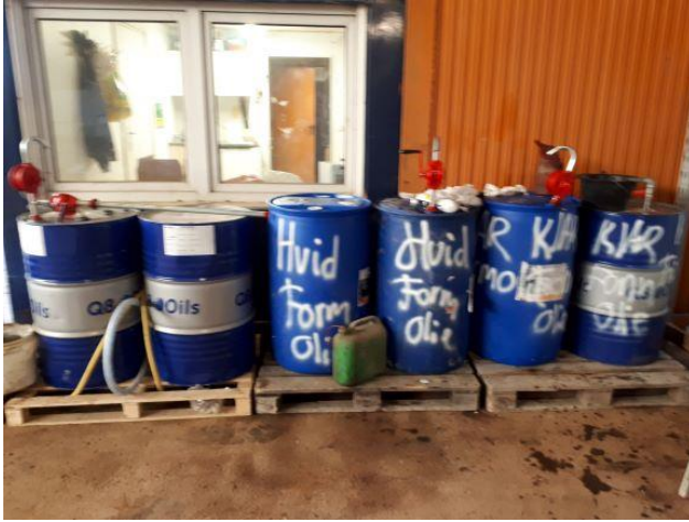
Opbevaring af olier på træpaller. Der ses lidt oliespild på betongulv. Det blev aftalt, at tønderne f.eks. opstilles på metalkar med rist til opsamling af spild.
