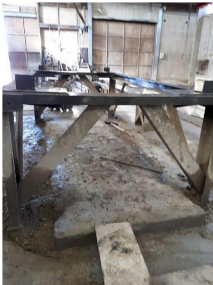
Vaskeplads for betonelementer
