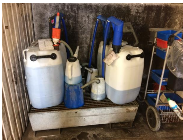
Opbevaring af motorolie og sprinkler- og kølervæske
