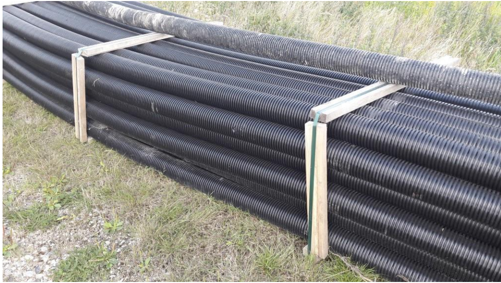
Drænrør med stor dimension
