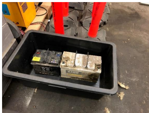
Billede af spildbakke til brugte akkumulatorer
