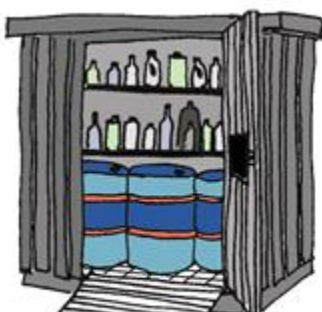
Figur 2 Udendørs opbevaring i container med dobbelt bund.
