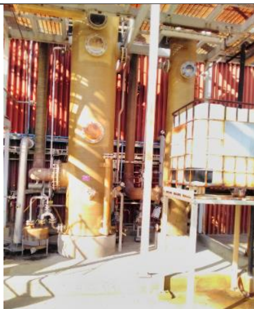
Figur 13. Basisk skrubber ved P1.
