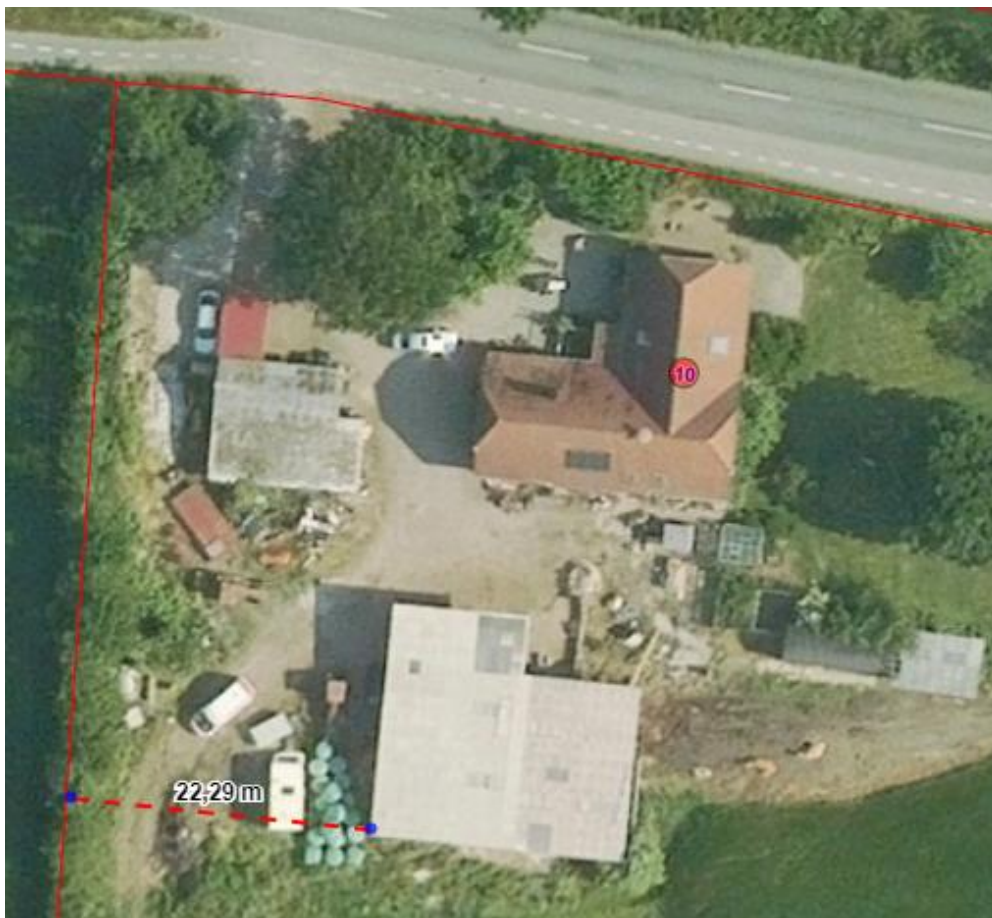
Kort 3. Afstandskrav på 30 m fra stald til naboskel mod vest er ikke overholdt.
