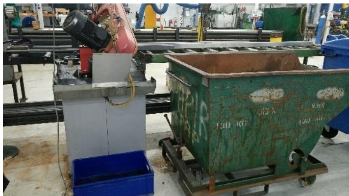
Billede nr. 5: Opbevaring af metalspåner. Bakke til opsamling af evt. spild under sav (2020)
