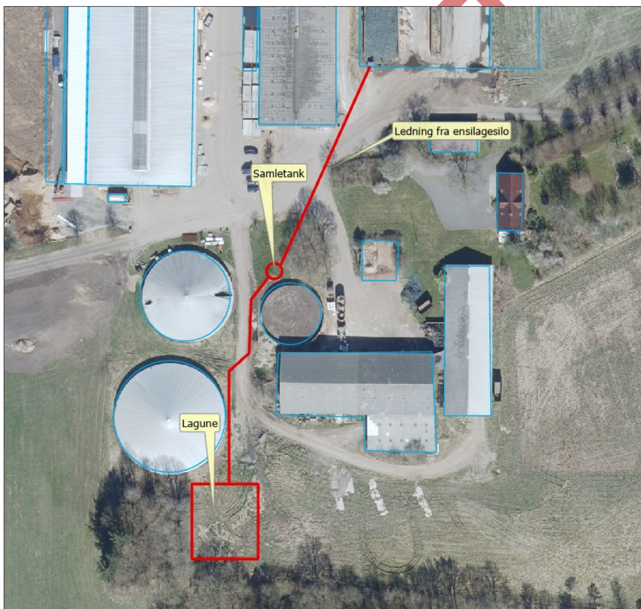
Figur 1. Lagune, samletank og ledningsføring.
