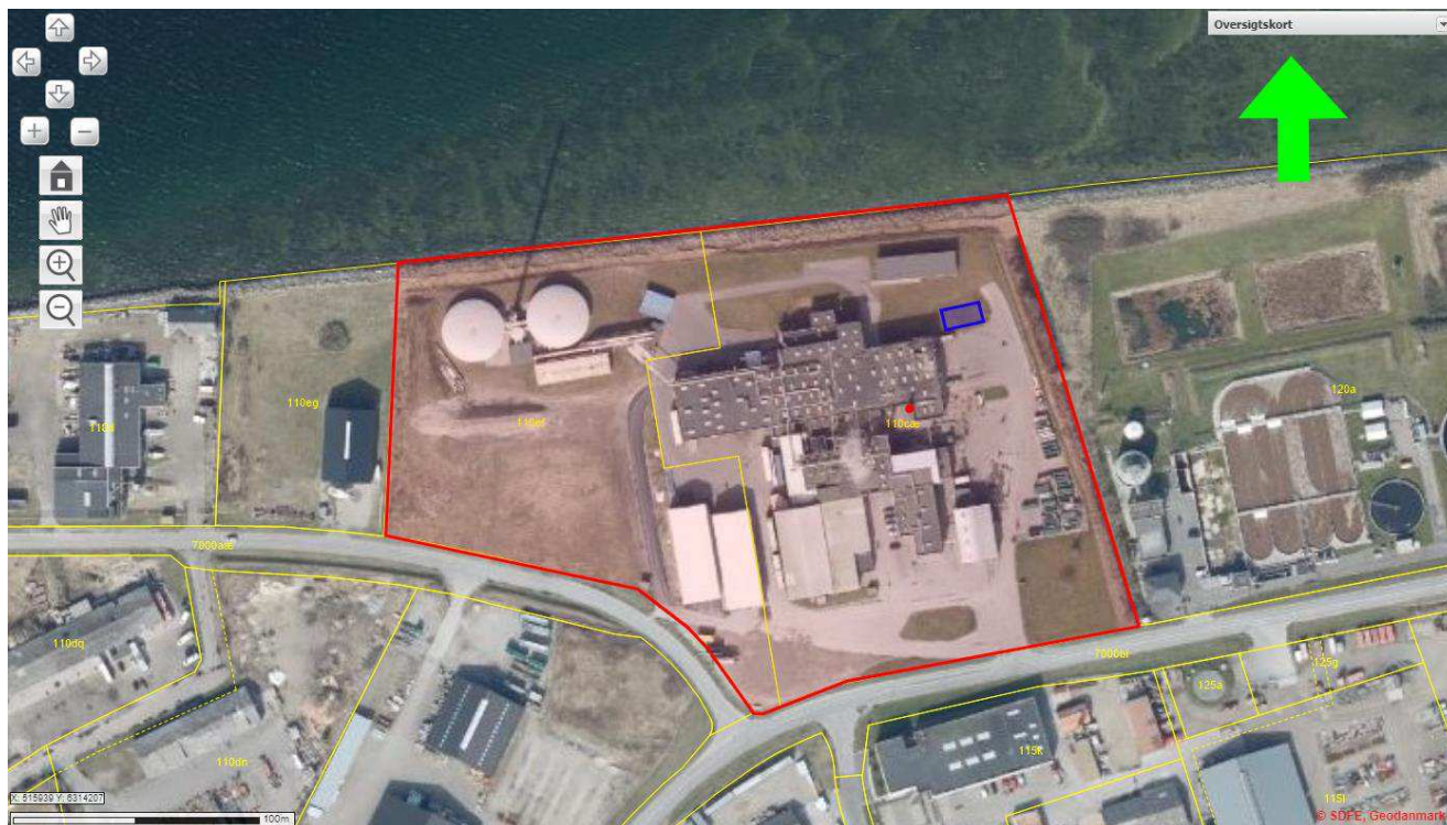
Figur D.1 Virksomhedens placering på de to med rød indrammede matrikler i erhvervsområde 2.E2.5. Mørkeblåblå kvadrat markerer placering af tanke til gasolie. Rødt punkt angiver afkastets placering. Nordpil med grøn.
