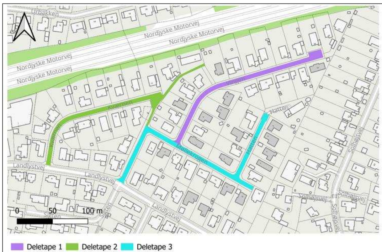
Figur 2: Deletaper for forestående kloakeringsarbejdet.
