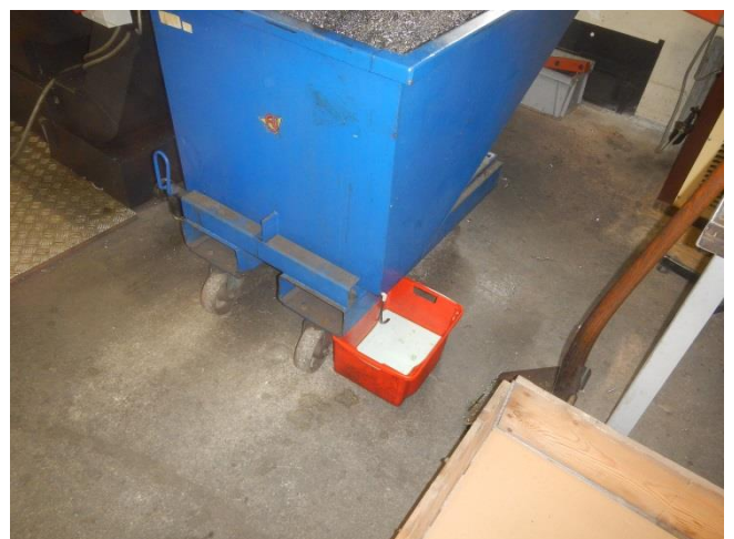
6. Produktionshal. Mindre container til drejespåner. Afdryp sker til opsamlingsbakke.
