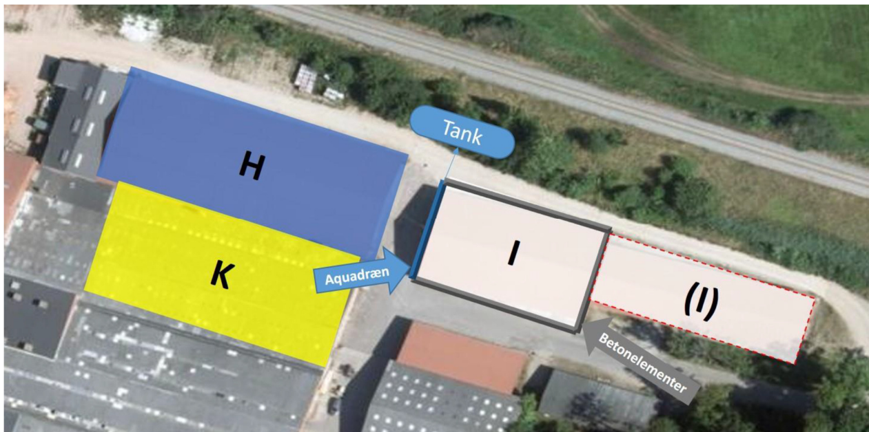
Figur 4: Skitse af placering af betonelementer, aquadræn og opsamlingstank til at kontrollere og opsamle af overfladevand fra område I.
