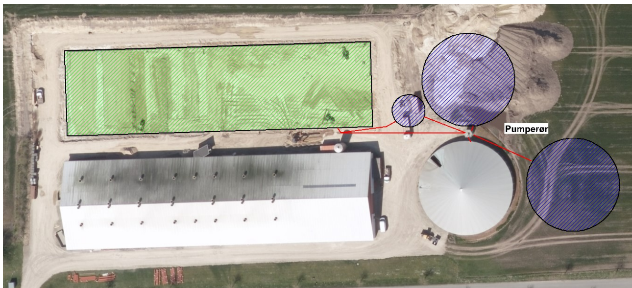
Billede 3 Placering af gylletanke med rørføring
