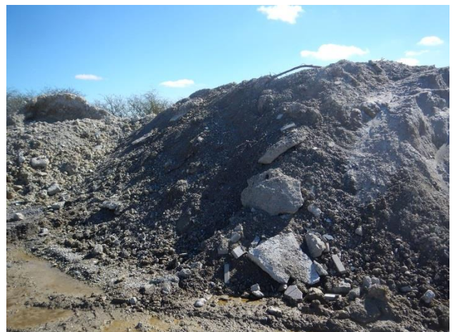
6. Affald i form af sand, grus og enkelte stykker beton. I dette oplag sås et mindre parti jord/lerjord indblandet i affaldet.
