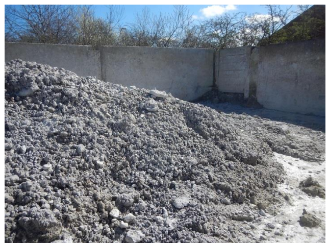
4. Betonaffald til hærkning i betonindhegning
