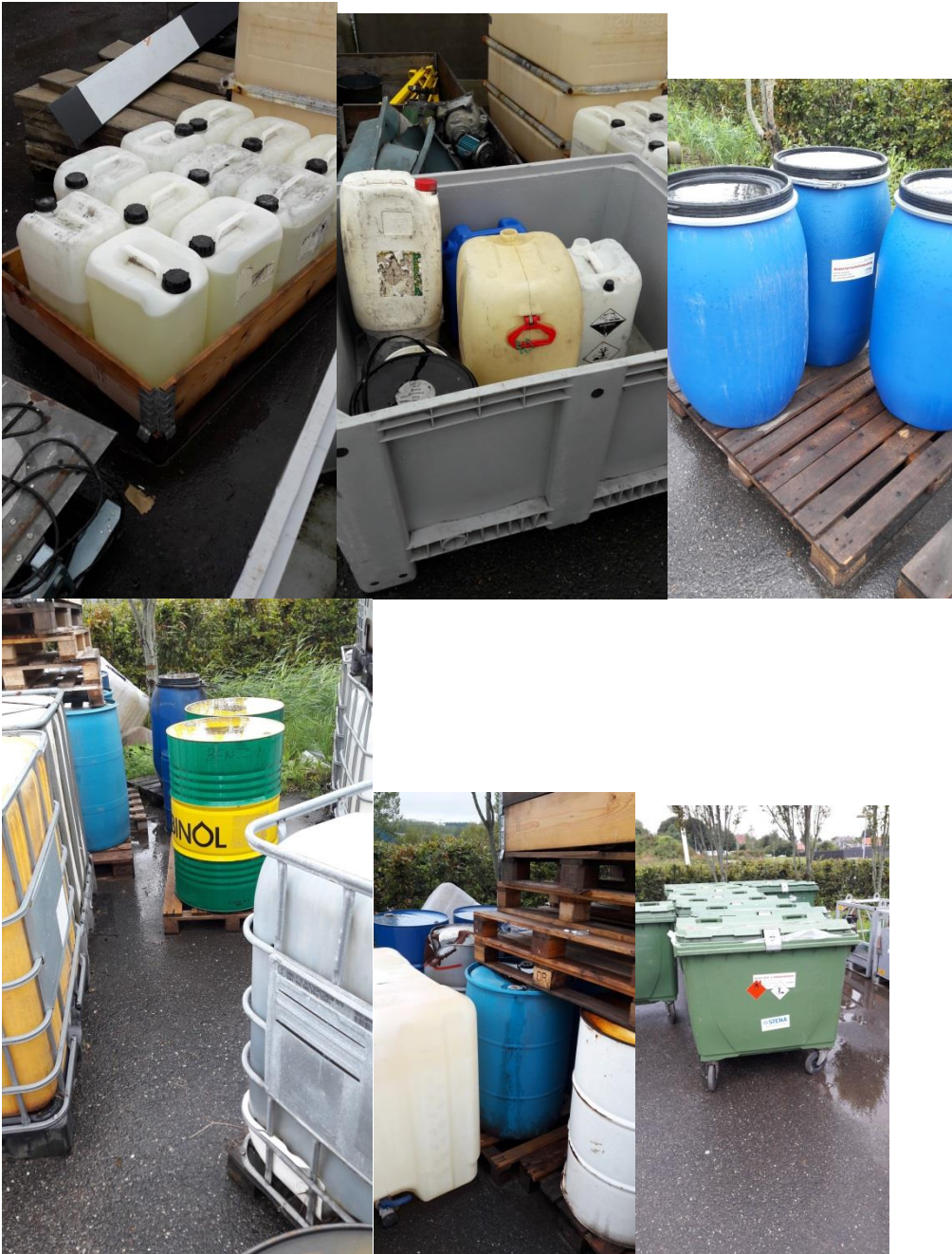
Figur 8 Udendørs oplag af farligt affald, og affald der afventer klassificering af Stena Miljø. Der er tromler med benzin, spildolie, og diesel, dunke med uspecificeret indhold, tromler mærket med "miljøfarligt husholdningsaffald", affaldscontainere mærket med "farvning og malingsemballage".
