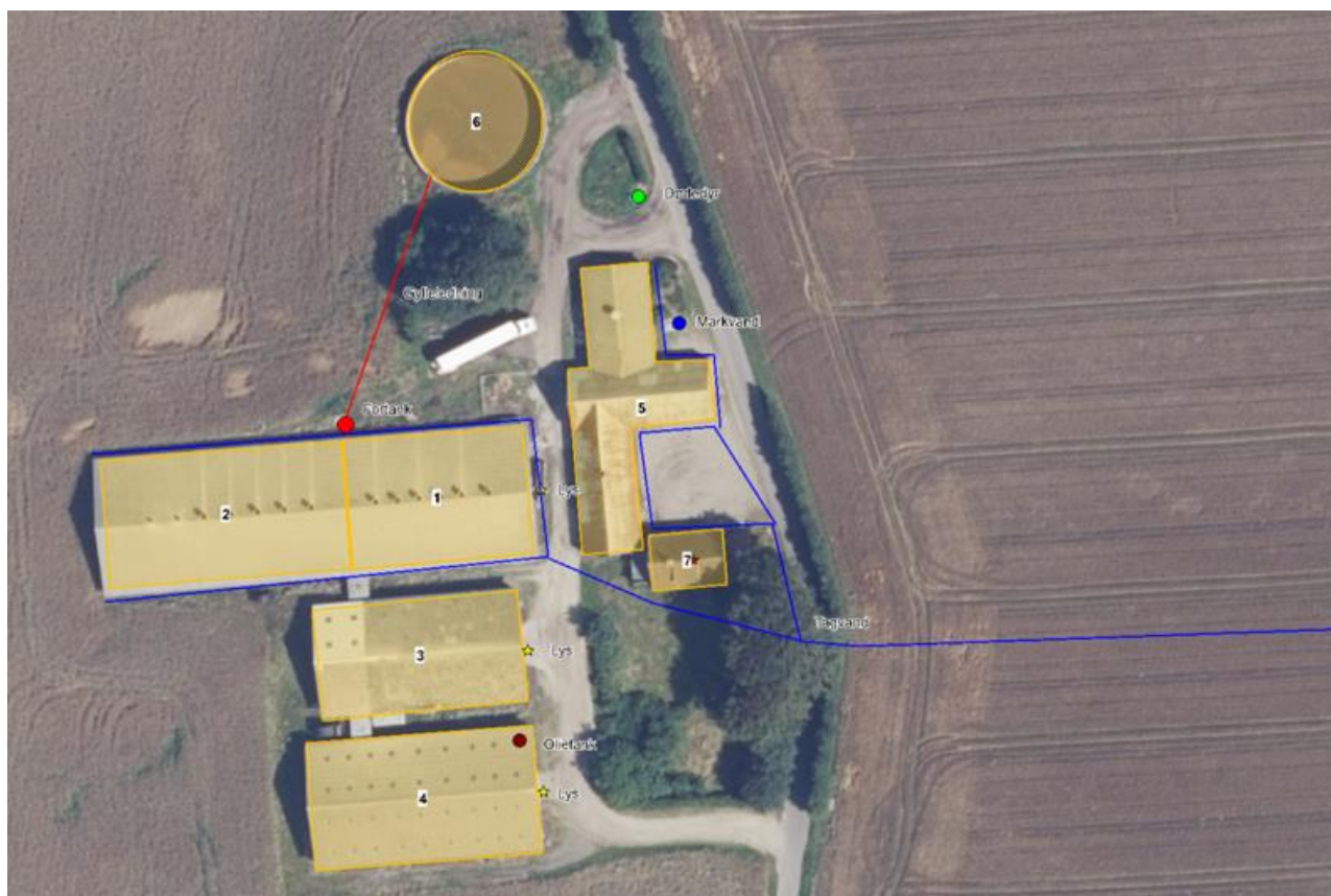
Figur 6. Tagvand fra nogle driftsbygninger ledes til drænen og bæk (markeret med blå). Rørføring fra fortank til gylletank (markeret med rød). Figur udarbejdet af ansøger.
