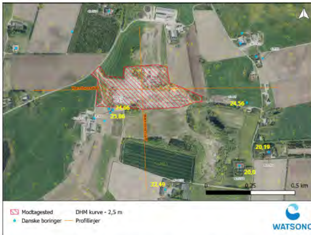
Figur 2.4: Oversigtskort påført koter for pejlede grundvandsspejl, som med sikkerhed repræsenterer det sekundære grundvandsmagasin (gul skrift).
