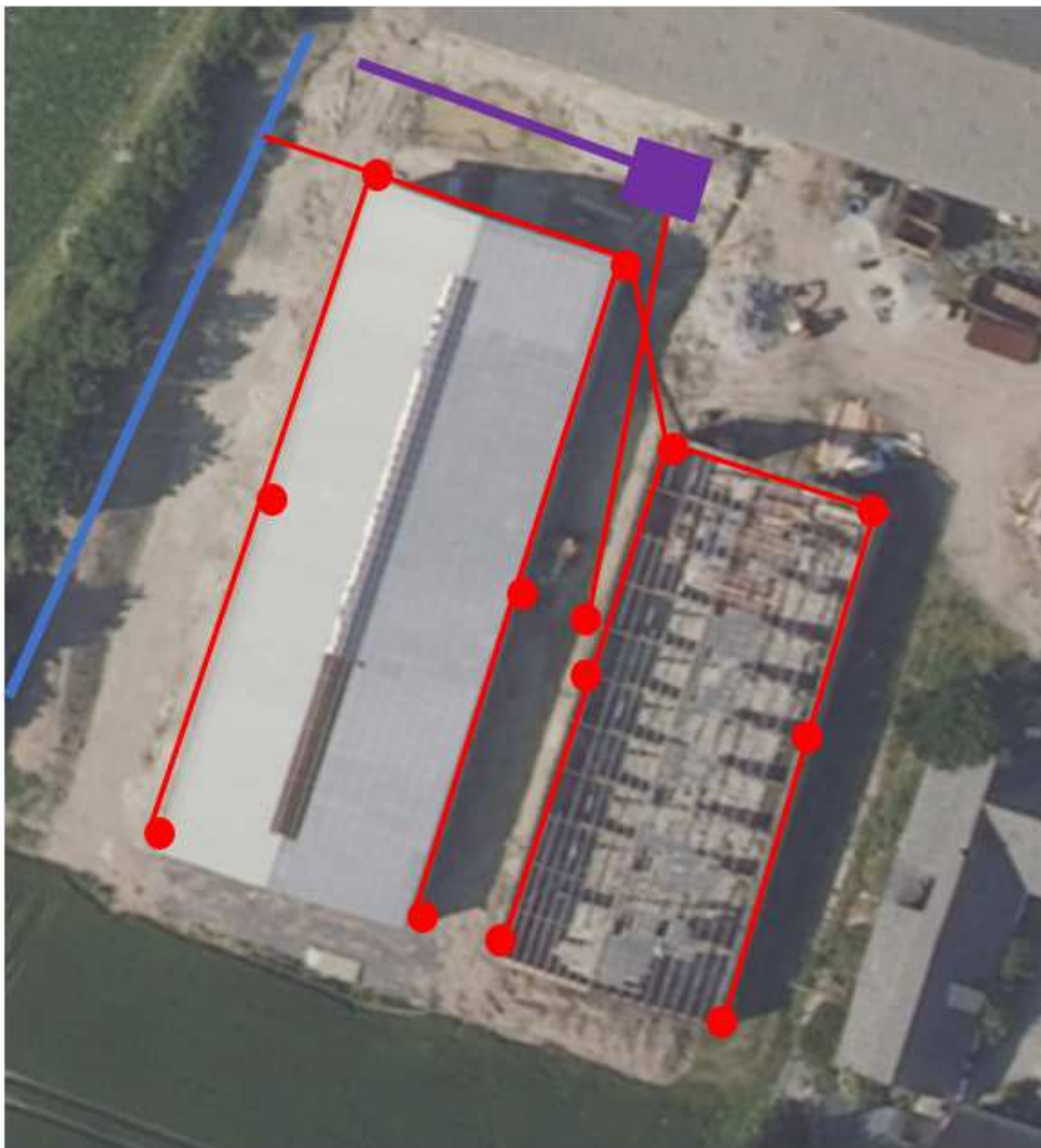
Figur 9 Rød tagnedløbstilslutning til dræn(blå) Lille forbeholder og opsamlingsgrav hertil på nordgavlen af stald 2.
