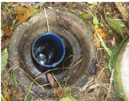
Foto 7: Boringen stod med filteret i et overfladenært grundvandsmagasin.
