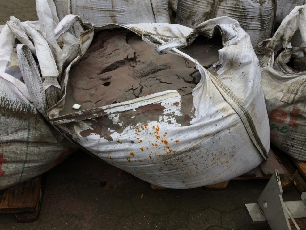
Billede 9 – En big bag med lækage /20 cm sprække
