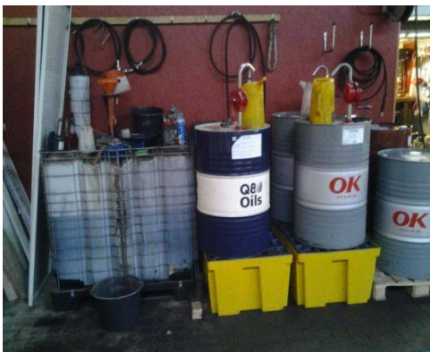
Uhensigtsmæssig opbevaring af spildolie udenfor spildbakke.
