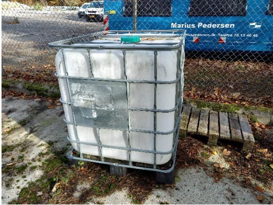
Billede 3: Palletank til værksteds gulvaskevand, der bortskaffes som farligt affald
