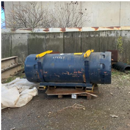
Tank ikke sikret mod påkørsel
