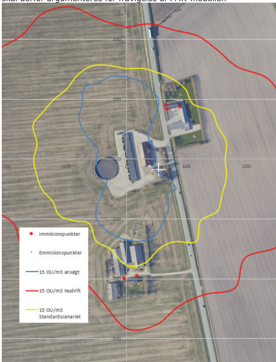
Figur 1. Grafisk præsentation af resultaterne af OML beregningen som ved isokurver viser, at de vejledende lugtgenegrænser er overholdt ved enkeltboliger i landzonen i ansøgt drift
