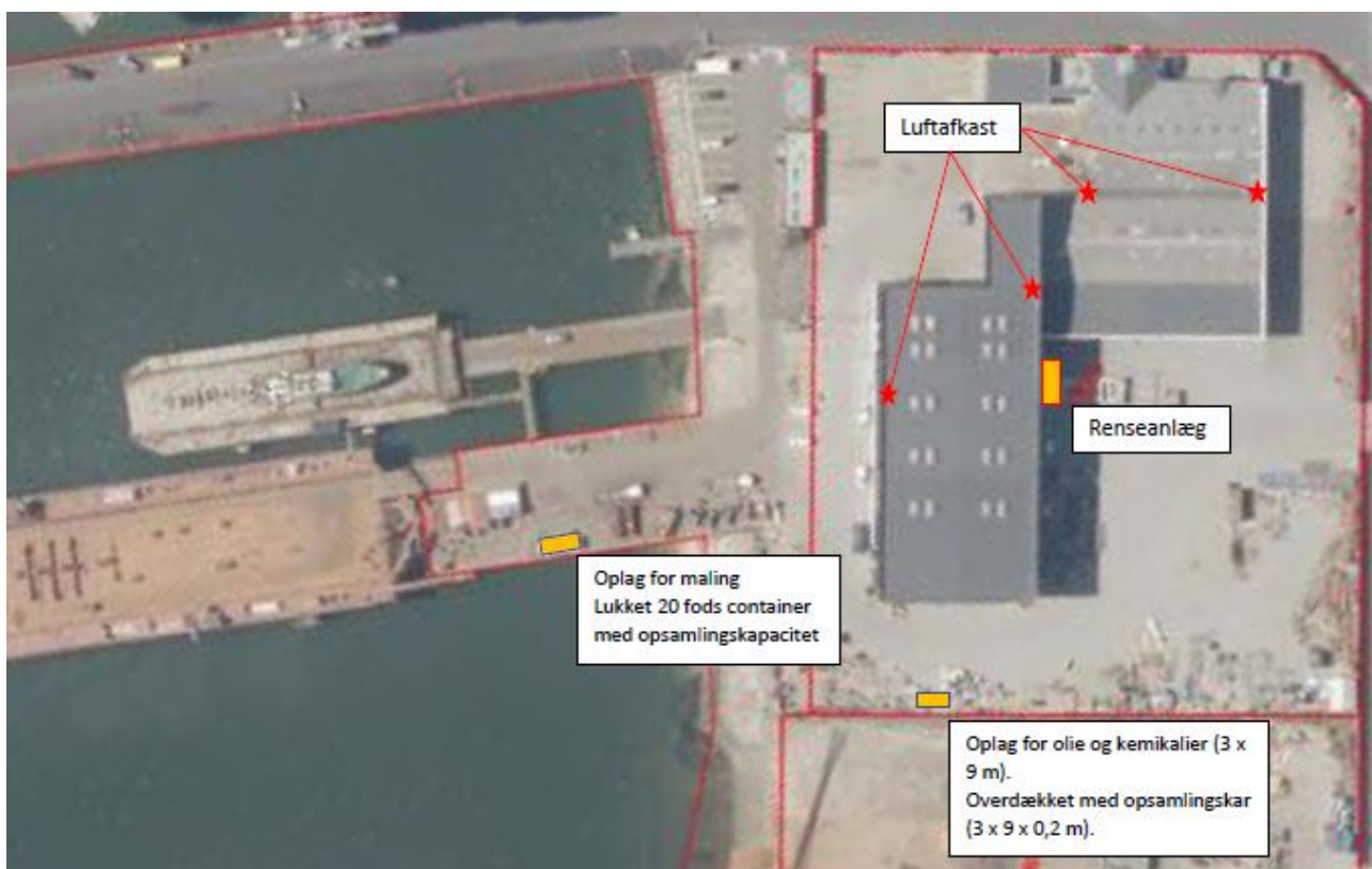
Fig 3. Placering af frie installationer, renseanlæg samt luftafkast.
