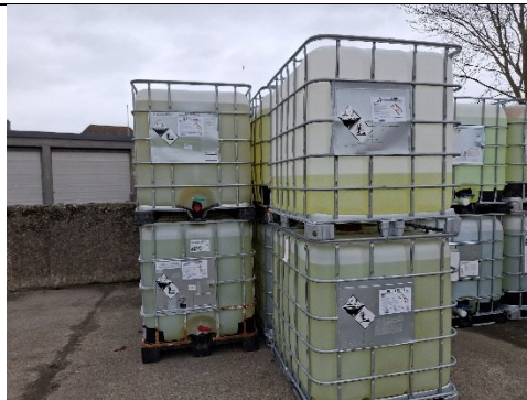
Hypochlorite UN 1791 i palletanke (på plads syd på fabriksområdet)
