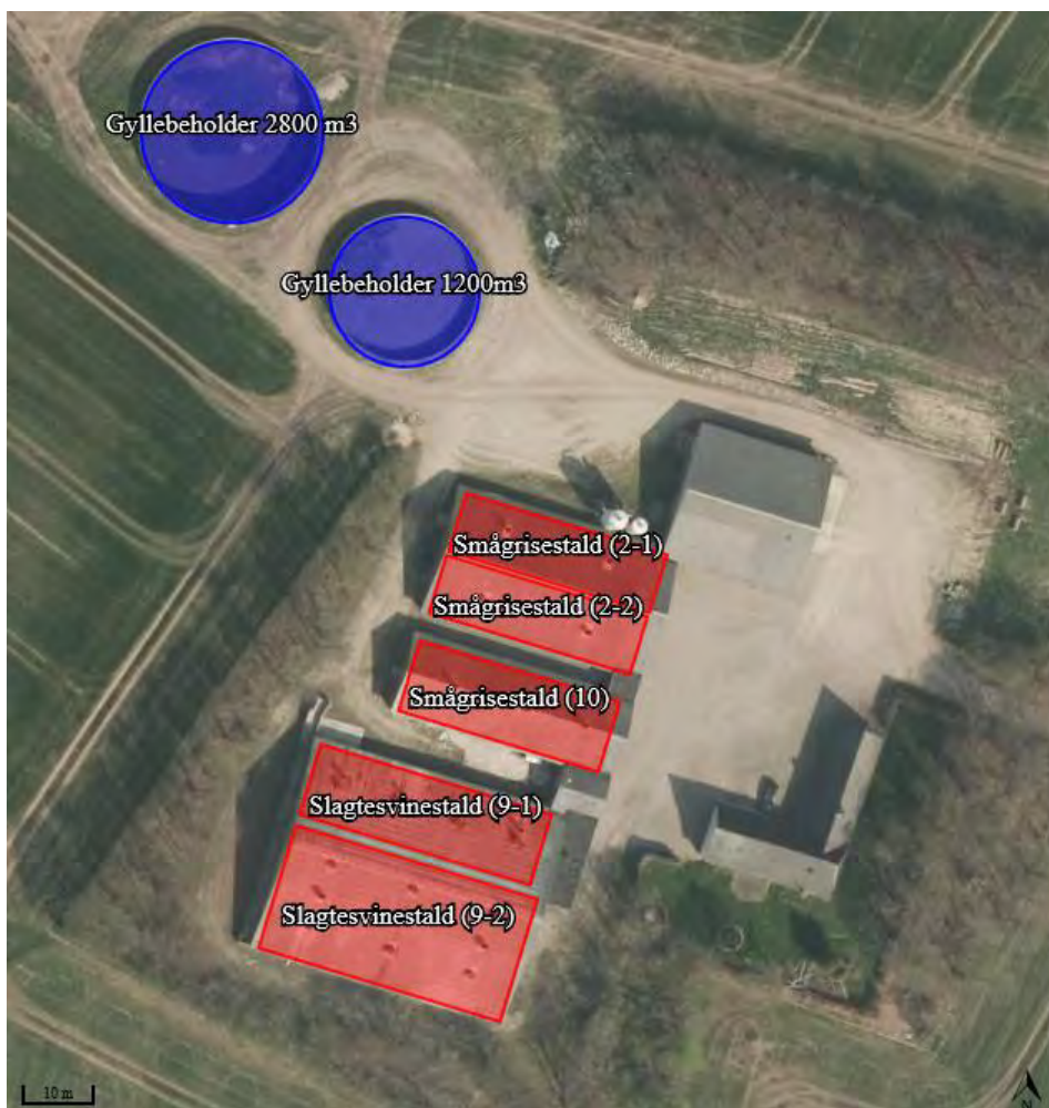
Figur 1: Husdyrbrugets stald- og opbevaringsanlæg. Foto: husdyrgodkendelse.dk
