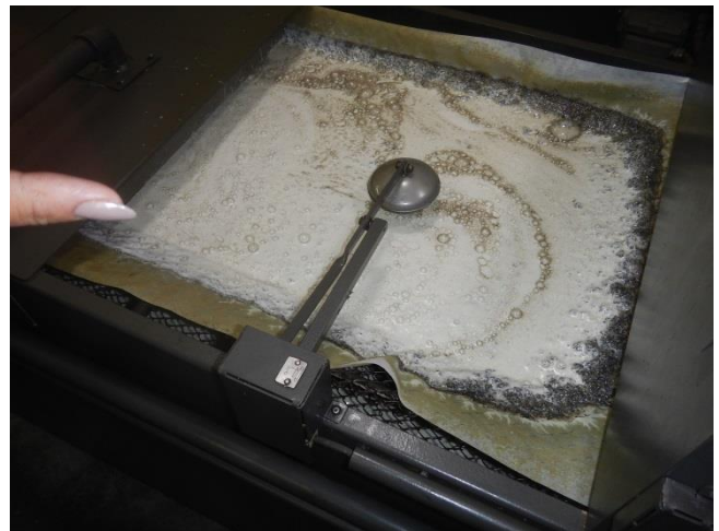
10. Filterdug til renholdelse af bore- skærevæske, der genbruges i CNC styret bearbejdningsmaskine
