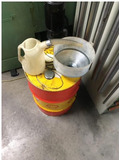
Spildolie opbevares i 100 liters tromle, uden spildbakke, men det vurderes at opbevaringen sker uden mulighed for spild til omgivelserne.
