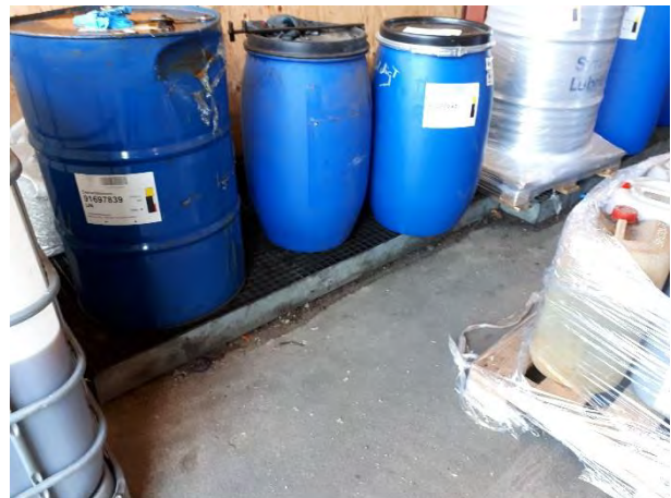
Foto 10: Opbevaring af i spunstromler og spændlågsfade på riste i hal 3 med indhold af olie
