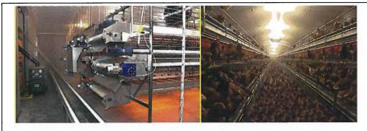
Figur 1 Billedet til venstre viser gødningsbåndene, som afleverer den faste gødning ved enden af systemet i en tværkanal/transportbånd, der transporterer den faste gødning ud af stalden. Til højre ses anlægget med høns. Billedet fra billed databasen, Videncentret for Landbrug, Fjerkræ.
