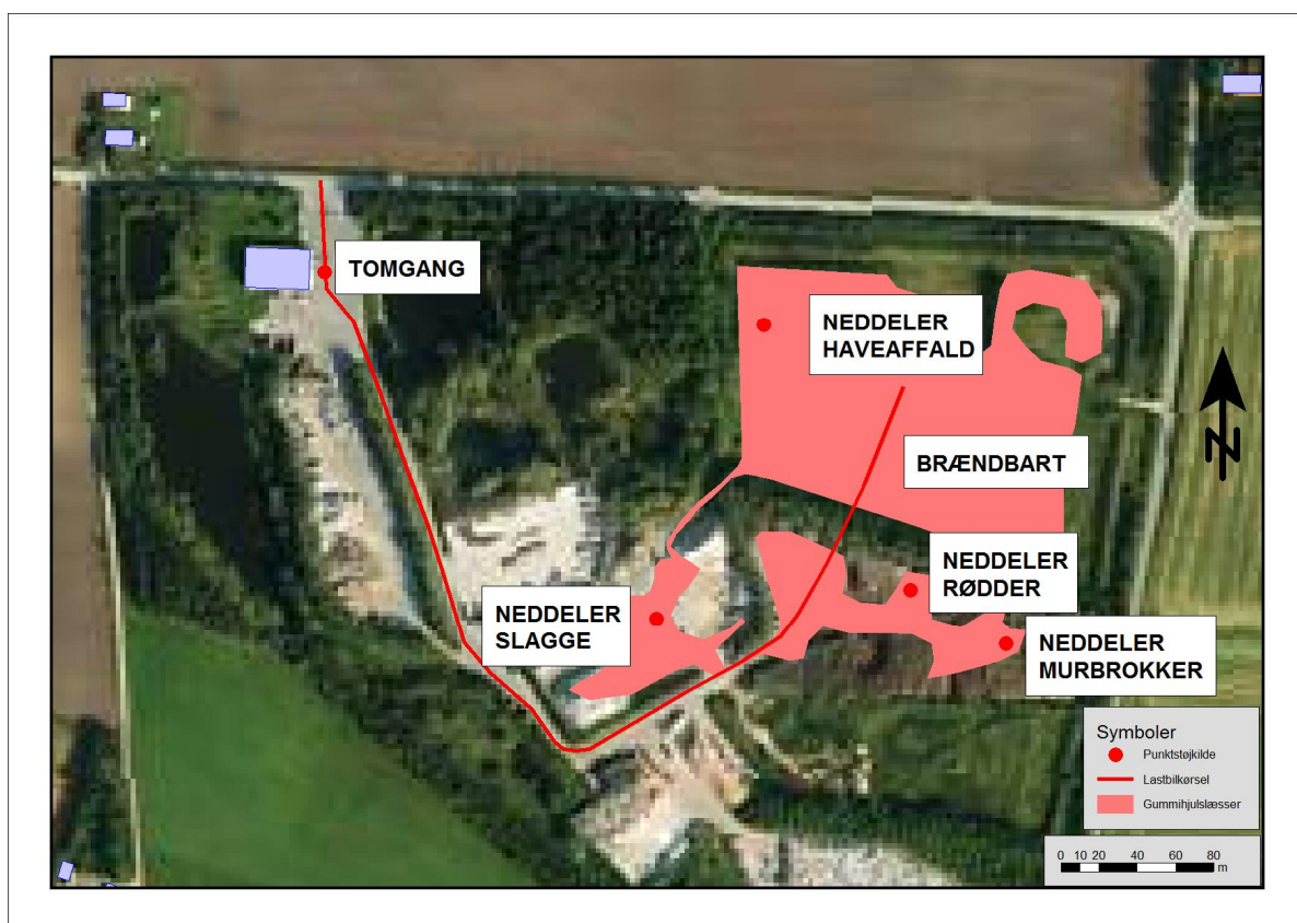
Figur 6: Placering af støjekilder. Operationsområderne for gummihjulslæssere mv. er tilpasset den benyttede terrænmodel, som indeholder jordvolde og materialebunker.
