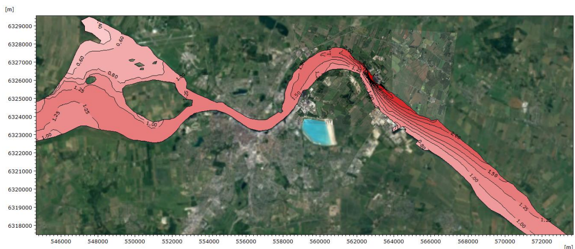
Figur 4-4. Temperaturforskel ved spredning af opvarmet kølevand (ca. 8,5 °C, svarende til estimeret statistisk maksimum temperaturpåvirkning fra drift af blok 3) fra Nordjyllandsværket under forhold med vestgående strøm. Simuleringsperioden har en varighed på en måned og mørkere røde farver indikerer varmere vand. (Baggrundsfoto er fra Google Earth, 2021).
