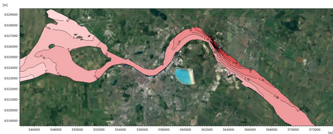
Figur 4-3. Temperaturforskel ved spredning af opvarmet kølevand (ca. 8,5 °C, svarende til estimeret statistisk maksimum temperaturpåvirkning fra drift af blok 3) fra Nordjyllandsværket under forhold med tidevandspåvirkning.
