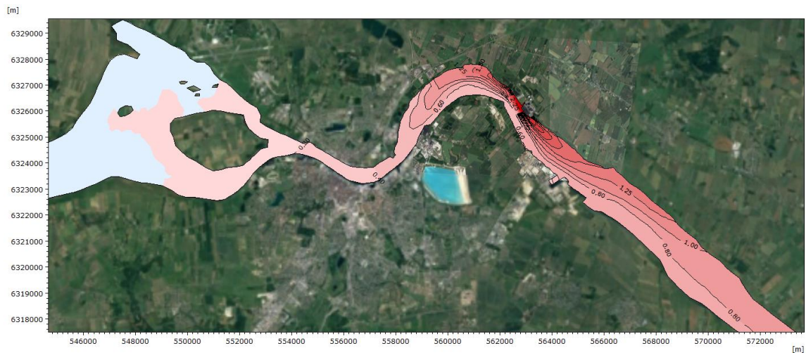
Figur 4-5. Temperaturforskel ved spredning af opvarmet kølevand (ca. 8,5 °C, svarende til estimeret statistisk maksimum temperaturpåvirkning fra drift af blok 3) fra Nordjyllandsværket under forhold med østgående strøm.
