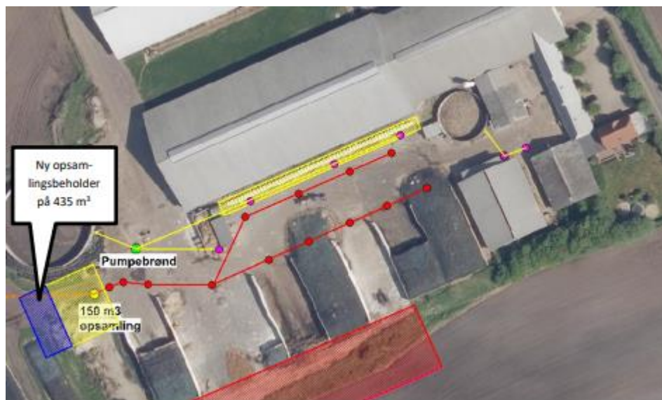
Figur 14. Afledning af overfladevand.
