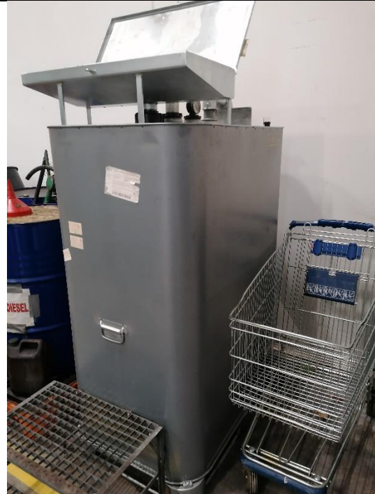
Foto 2. Spildolietank uden tankattest.
