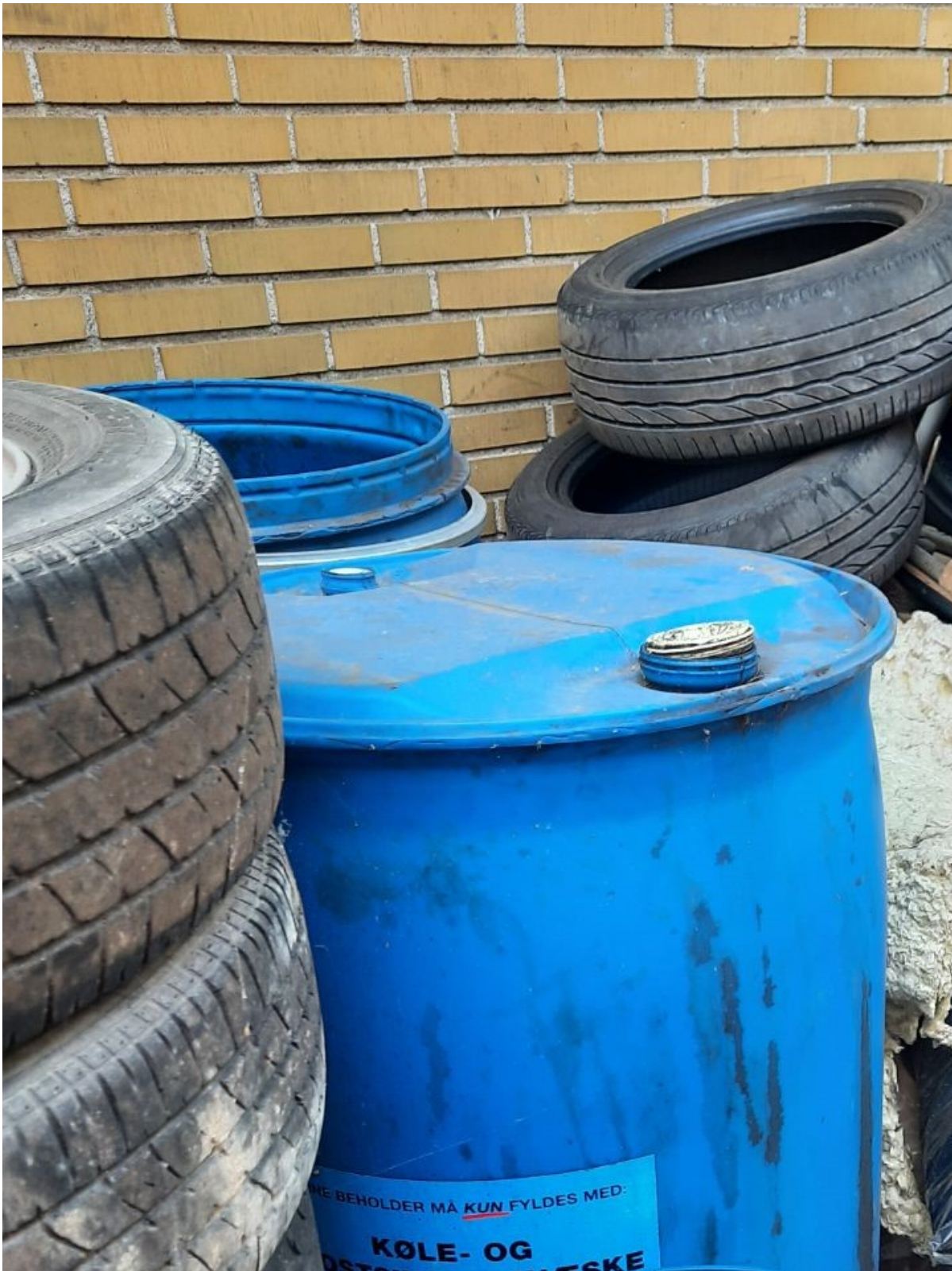
Figur 2 Beholder til brugt kølevæske og beholdere der har indeholdt olie, opbevares udendørs.
